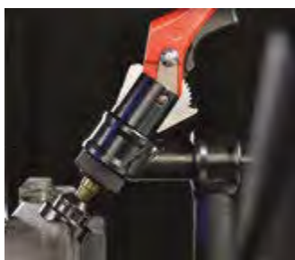
Прижимно-вставные детали с V-блоком Зажим труб круглого/прямоугольного сечения
