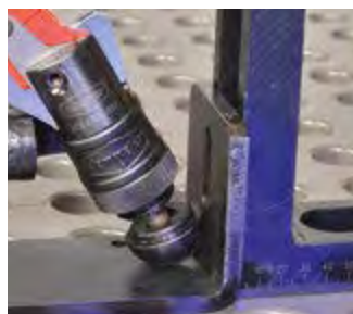
Зажимной диск шаровой формы Зажим угловых профилей
