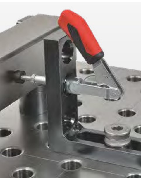
^ Шатунное зажимное приспособление с резьбовой втулкой
