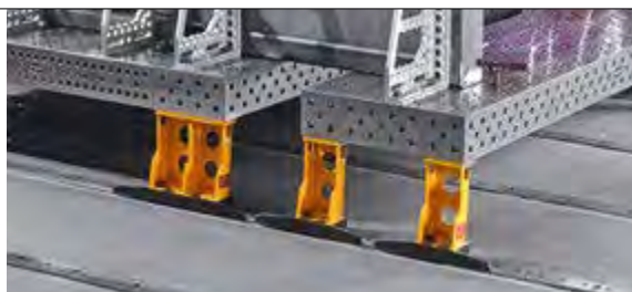
Verschuiven van opgebouwde systeemdelen zonder hijswerktuig of kraan mogelijk.
