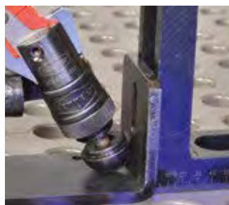
Aandrukschotel met kogelvorm Opspannen van hoekprofielen
