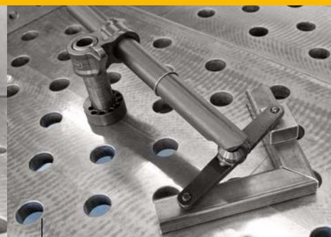
È possibile il bloccaggio in più punti grazie a un ponte di bloccaggio (il tubo di bloccaggio può essere orientato).
