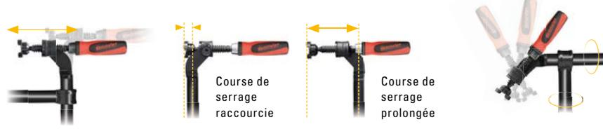
Plage de réglage de la broche de serrage supérieure à 130 mm grâce au retournement du support tubu. Cette nouvelle conception permet de procéder au serrage simple des pièces à usiner rapprochées ainsi que des pièces à usiner plus éloignées du perçage suivant du système.
