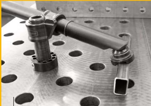
Une grande zone de serrage plate permet une multitude de variantes de serrage.
