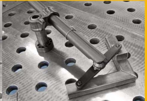
Posibilidad de sujeción multipunto mediante un puente de sujeción (tubo de sujeción orientable).
