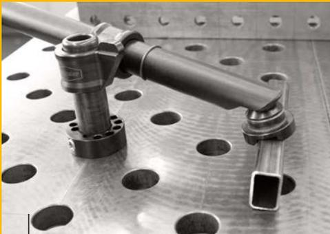
Ein großer flacher Spannbereich ermöglicht eine Vielzahl von Spannvarianten.
