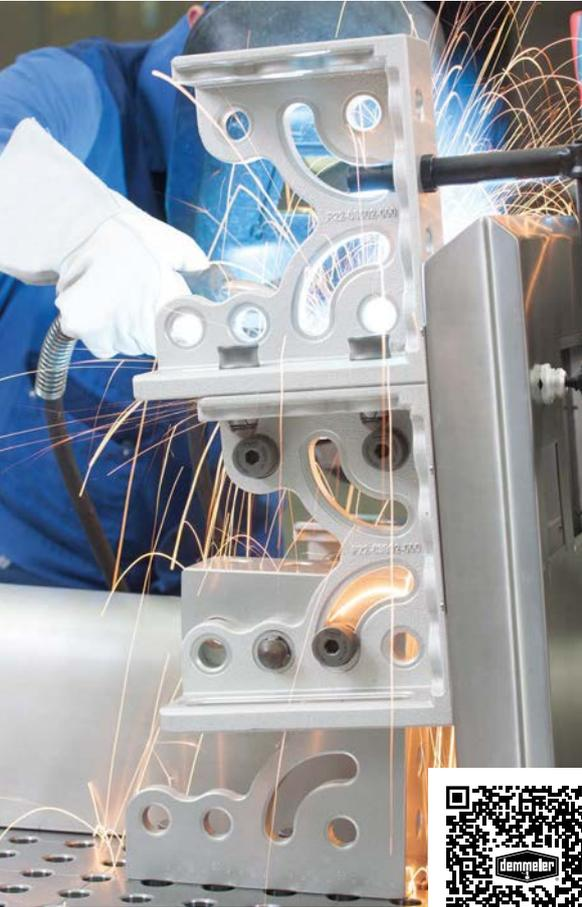
**90°-Systemnut in Nierenform ermöglicht stufenlose Winkeleinstellungen**
