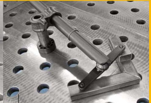
Mittels Spannbrücke Mehrpunktspannung möglich (Spannrohr ist schwenkbar).
