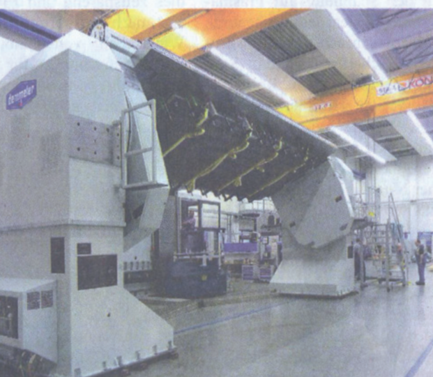
ation für die Aufspannung von Großteilen, Aufspannrahmen 200 mm, Zuladung 15 Tonnen
