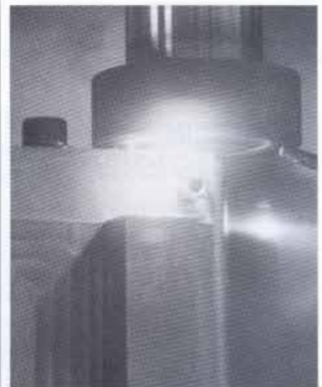
Hochtemperatur-Tribologieversuch Stift auf Scheibe.
